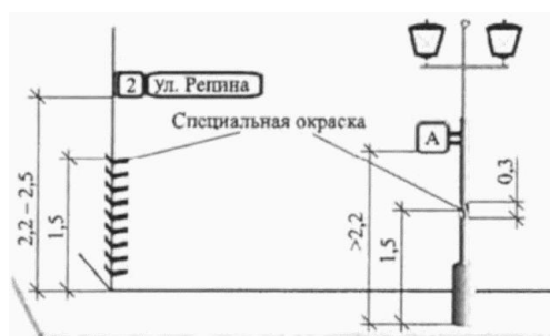
Рисунок 75 - Особенности размещения и параметры визуальных указателей в пределах пешеходного пути
