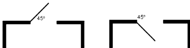
Рисунок 32 — Наружное и внутреннее открывание одностворчатой двери
