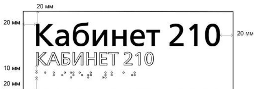
Рисунок 26 - Фон рабочего поля в соотношении с границами визуальной и тактильной информации
