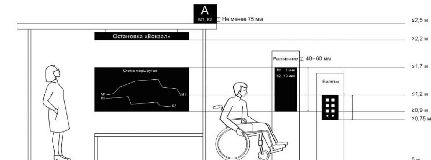
Рисунок 29 - Параметры размещения средств информации на остановочных пунктах
