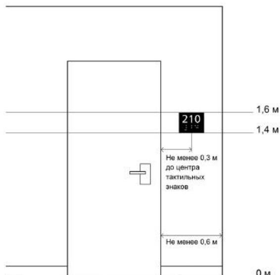
Рисунок 9 - Размещение информации относительно полотна двери
