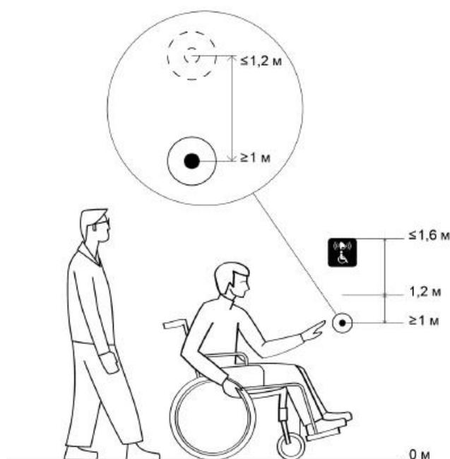
Рисунок 36 - Высота размещения кнопки вызова и информирующей таблички
