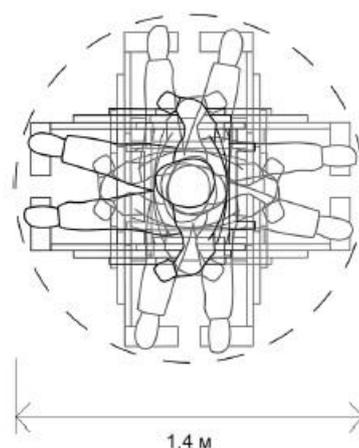
Рисунок Б.3 - Пространство для самостоятельного разворота
