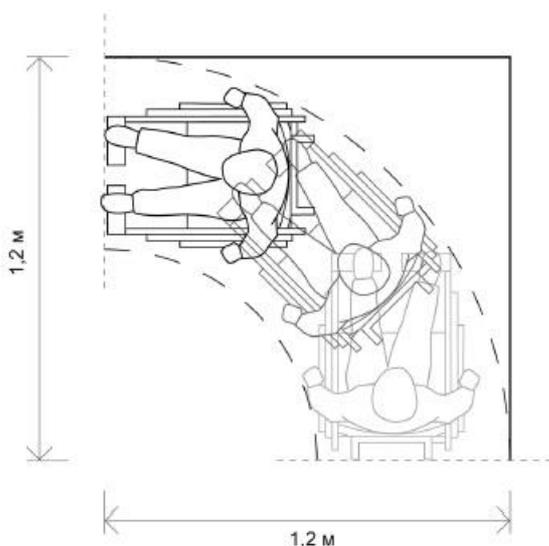
Рисунок Б.2 - Пространство для поворота на 90°
