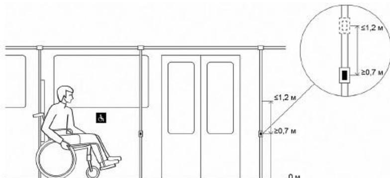
Рисунок 38 - Расположение кнопок вызова персонала на поручнях транспортных средств
