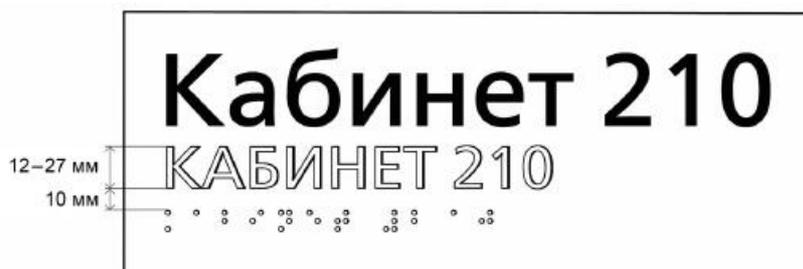
Рисунок 32 - Высота РЛШ при сочетании с плоскочечатным шрифтом (в данном случае знаки РЛШ и РТШ рекомендуется выполнять прозрачными или в цвет подложки)
