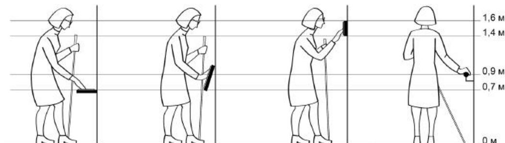
Рисунок 30 - Высоты размещения тактильной информации
