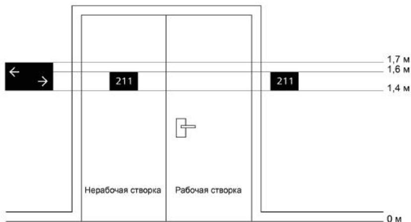
Рисунок 8 - Вариант размещения информации на нерабочих створках дверей
