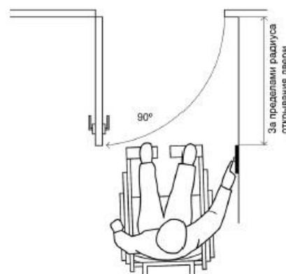
Рисунок 37 - Размещение кнопки вызова у дверного проема
