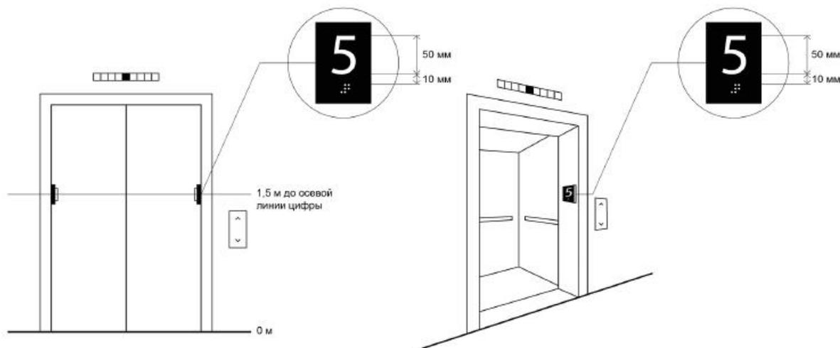
Рисунок 34 - Обозначения номера этажа на боковых поверхностях дверных проемов лифтовой шахты
