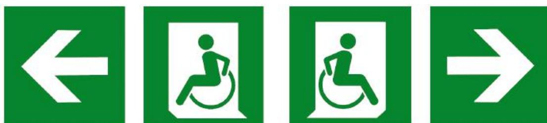
Рисунок 21 - Знак "Направление движения к выходу для инвалидов на кресле-коляске"
