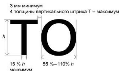
Рисунок 24 - Пропорциональные соотношения элементов шрифтовых знаков
